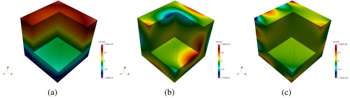
Figure 3 : Exemple de modes de Steklov calculés sur un cube homogène : les modes sont aussi normalisés entre -1 et +1, les isovaleurs sont représentés sous forme dégradée. (a) Mode localisé dans le volume et sur la frontière (b) Mode des surfaces et des arrêtes (c) Mode des arrêtes
