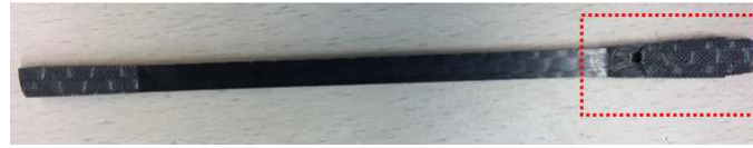
FIGURE 9 – Éprouvette orientée à 0° de [C_{10}] à rupture
